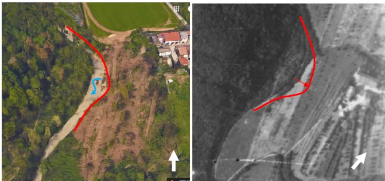
Figura 37: argine sinistro in erosione, in località C.na Campaccio. (Sinistra ortofoto Google 2016, destra foto aerea IGM 1936)
